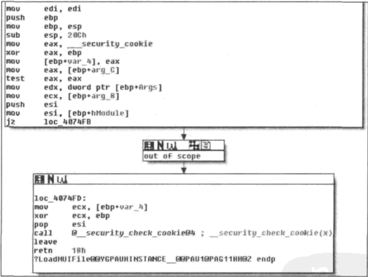
图 C-2 函数前导和出口处的安全 cookie（/GS）引用（IDA Pro）
