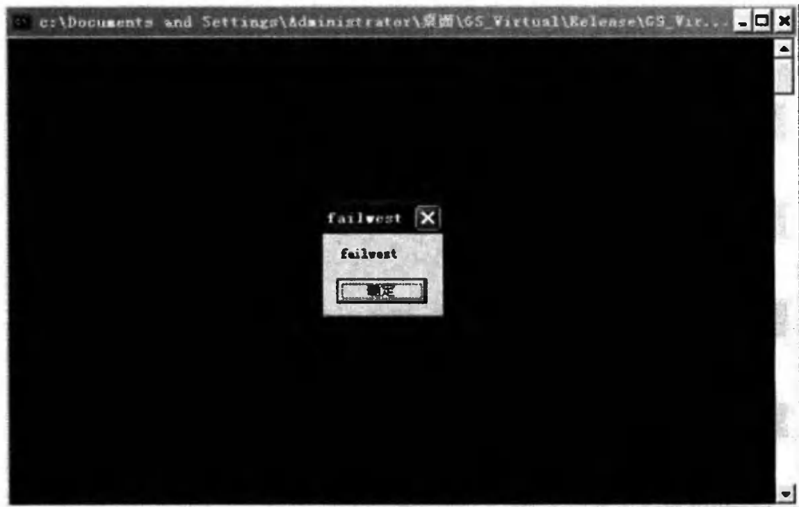
图 10.3.5 利用虚函数成功绕过 GS
