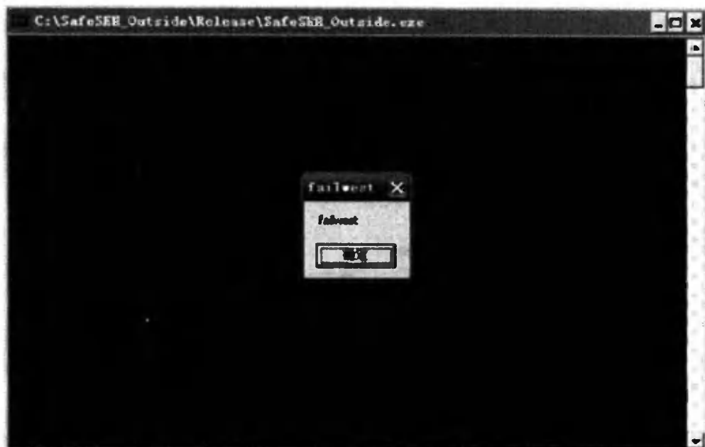
图 11.6.8 成功利用加载模块之外的地址绕过 SafeSEH
