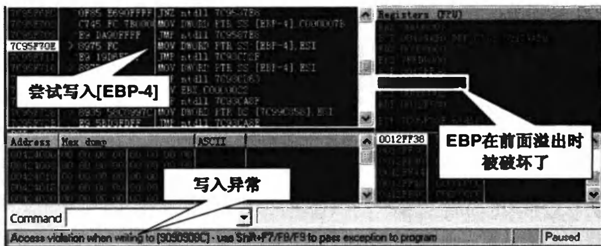
图 12.3.6 EBP 在溢出时被破坏
