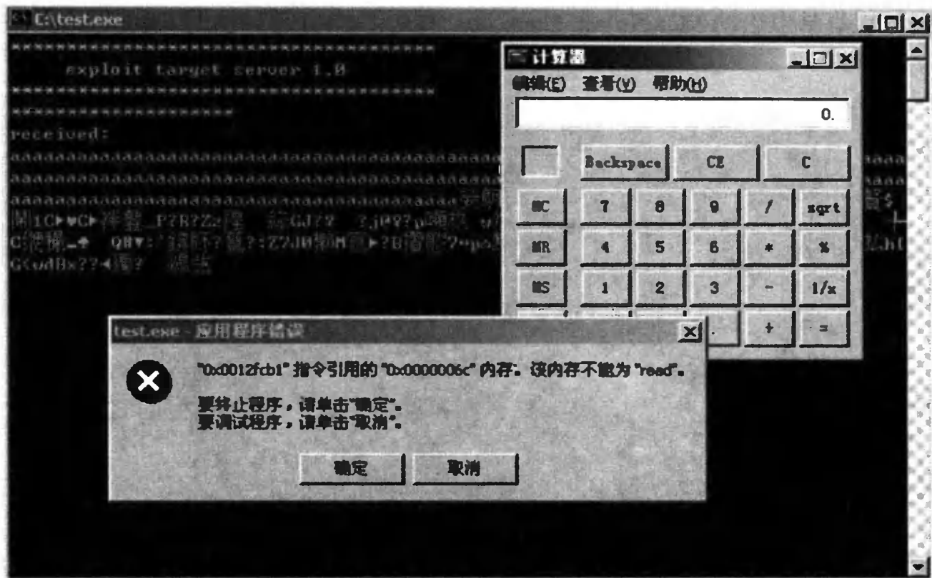
图 4.6.2 shellcode 得到执行
