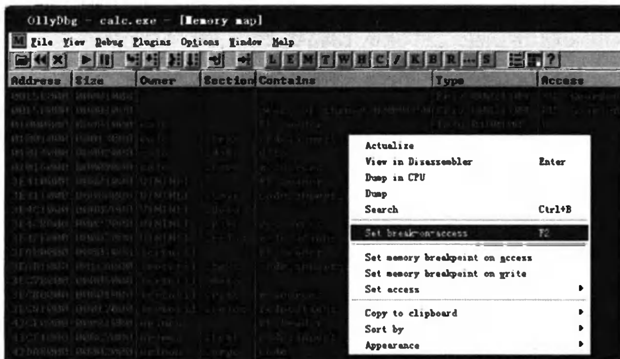
图 25.2.14 在 OllyDbg 中的内存段上设置一次性断点
