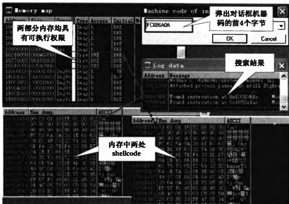
图 12.6.2 shellcode 在内存中的位置
