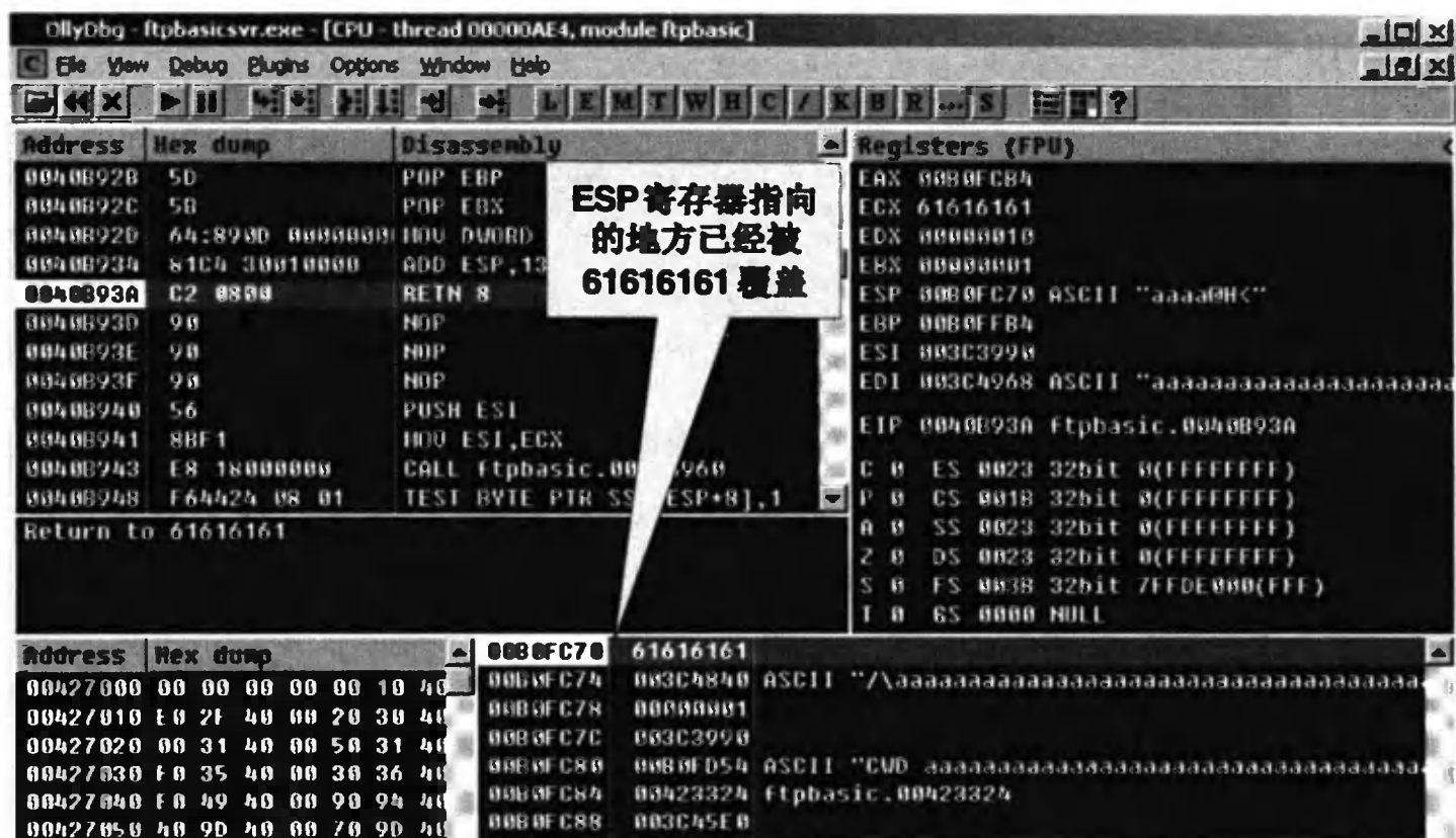
图 18.4.5 通过 OllyDbg 跟踪到程序处理 CWD 命令函数时发生了溢出错误
