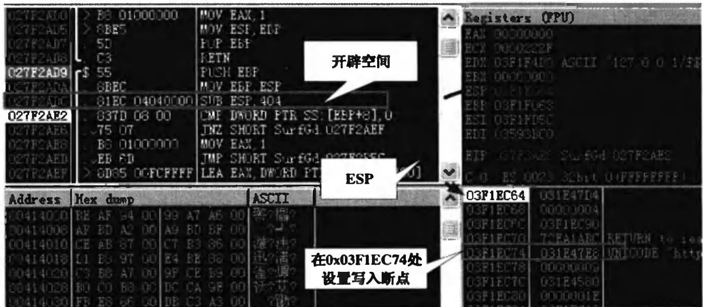
图 31.3.4 设置内存写入断点
