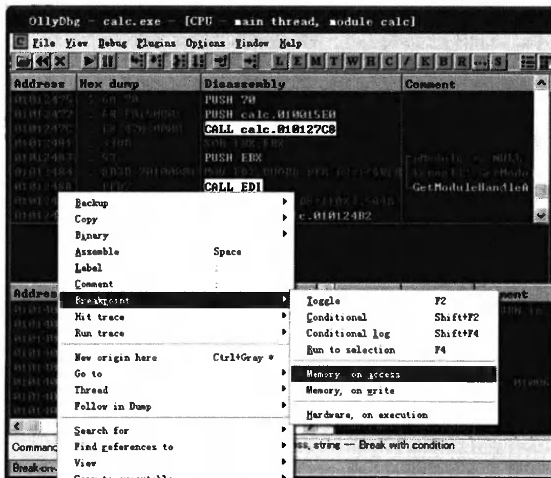
图 25.2.12 在 OllyDbg 中设置代码的内存断点
