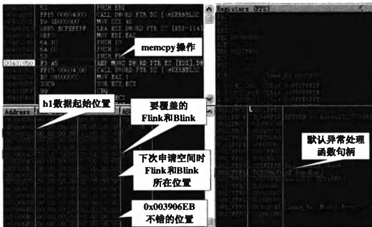
图 15.3.4 执行 memcpy 前内存状态
