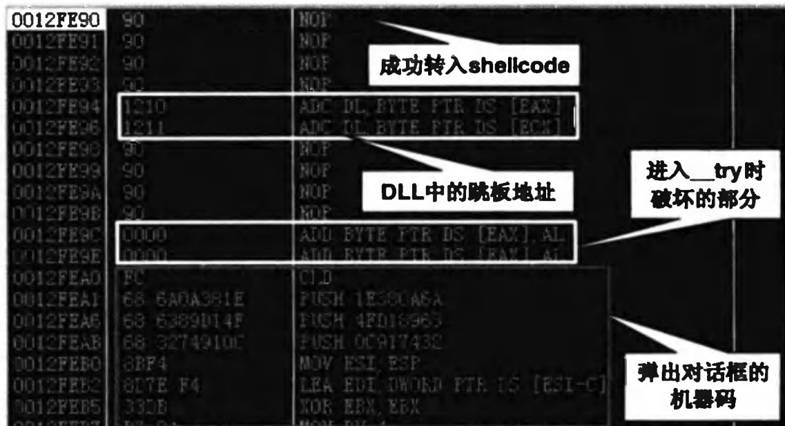
图 11.5.9 成功转入 shellcode 执行
