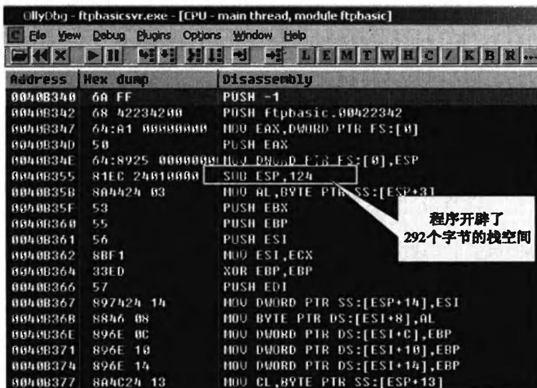
图 18.4.4 通过 OllyDbg 跟踪到程序处理 CWD 命令函数时发生了溢出错误
