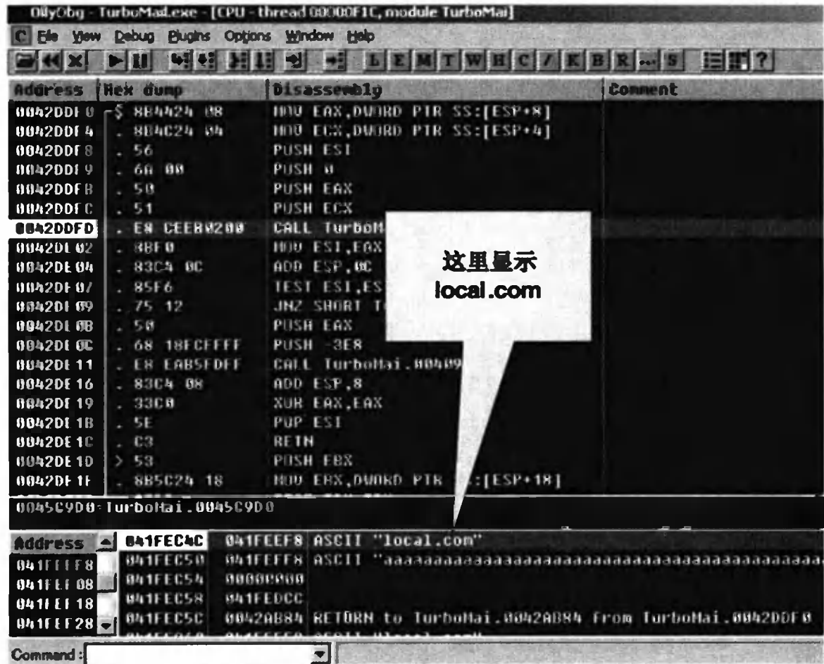
图 19.2.12 注意 OllyDbg 程序堆栈窗口出现了“local.com”字眼
