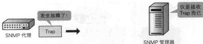
图 5.1.16 通过 SNMP Trap 检测到故障
