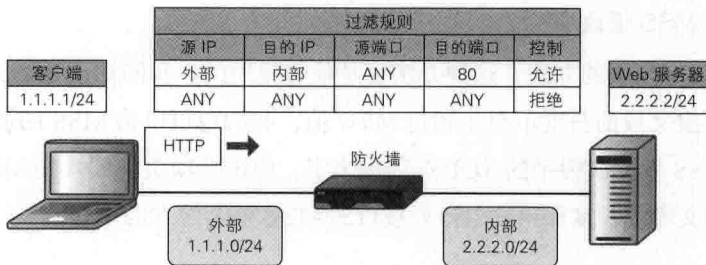
图 3.1.23 有助于我们了解状态检测的结构实例
