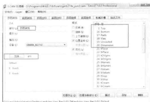
图8-13 顶层铜箔层选择及文件后缀
