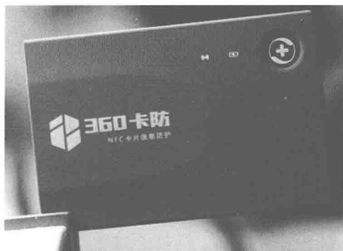
图9-77 HackID Pro的沉金PCB板 图9-78 360卡防将沉金Logo做成了触摸开关
