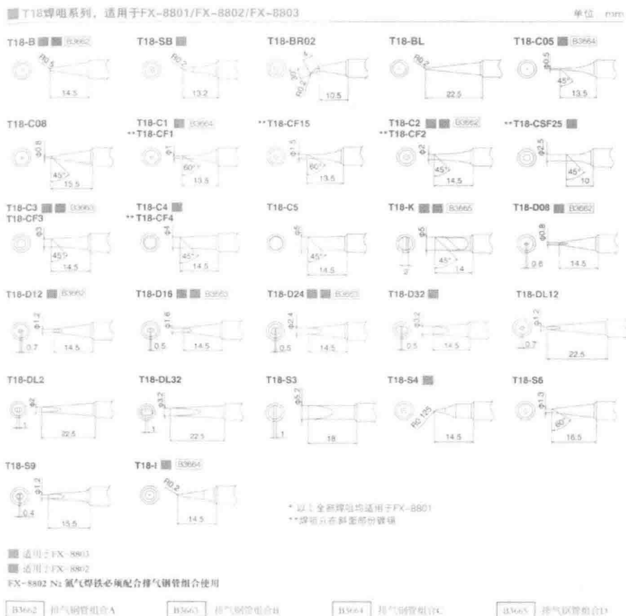
图2-15 白光烙铁头规格书（来源：HAKKO官方网站）
