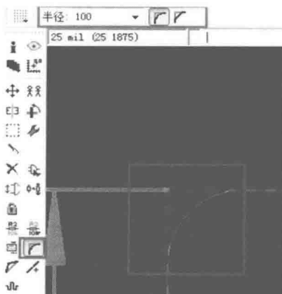
图9-55 将四边尖角拉成圆角
