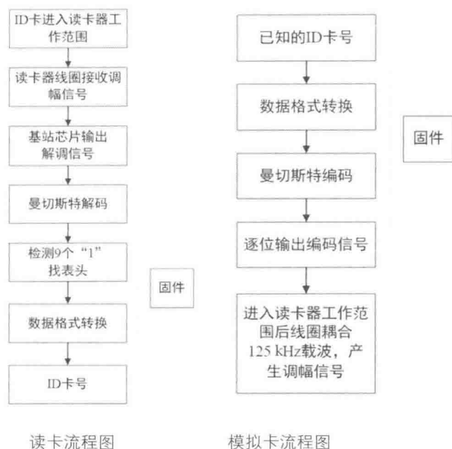
图6-31 读ID卡和模拟ID卡的流程图
