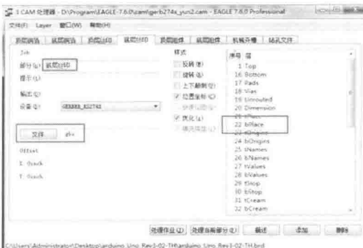
图8-16 底层丝印层选择及文件后缀
