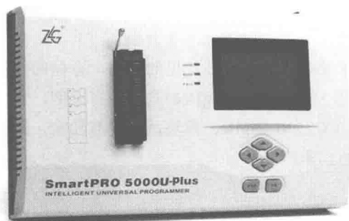
图3-85 ZLG SmartPRO 5000U-Plus编程器
