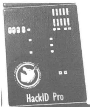
图9-77 HackID Pro的沉金PCB板 图9-78 360卡防将沉金Logo做成了触摸开关
