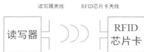
图6-6 电磁辐射方式的RFID系统
