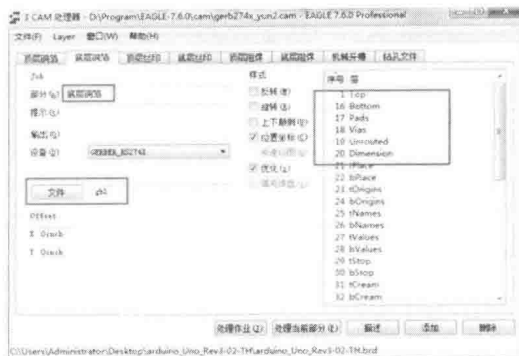
图8-14 底层铜箔层选择及文件后缀
