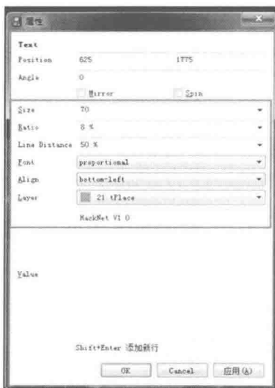
图9-58 设置丝印字体参数
