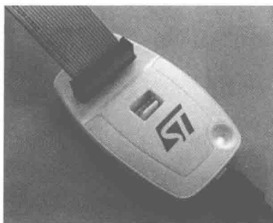
图3-79 STM8/STM32 ST-Link V2编程器
