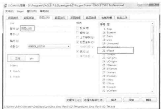
图8-15 顶层丝印层选择及文件后缀
