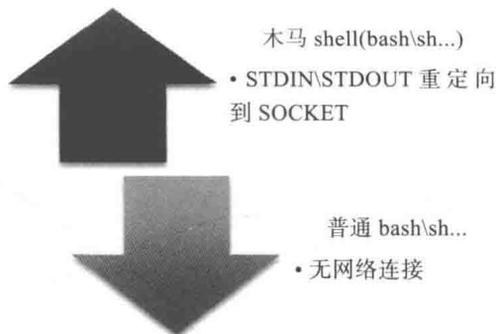
图 8-31 常规 Linux 反连 shell 检测思路
