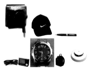
图7-11 图中的笔可用来录音,其他物品都带有隐藏的具备录音功能的彩色摄像机
